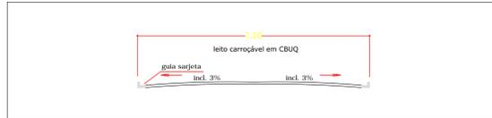
SECÇÃO TRANSVERSAL DA PAVIMENTAÇÃO ASFÁLTICA
