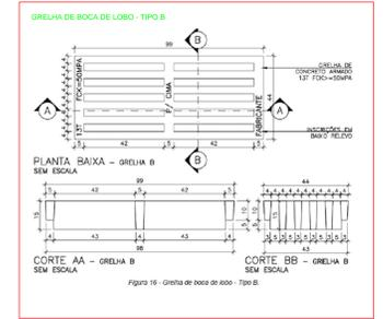
Figura 16 - Grelha de boca de lobo - Tipo B
