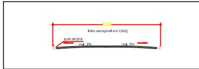
SECÇÃO TRANSVERSAL DA PAVIMENTAÇÃO ASFÁLTICA
