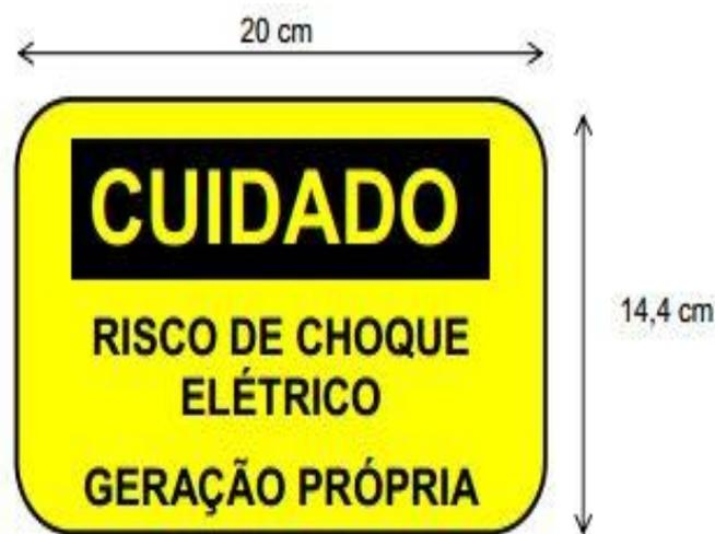
Figura 4: Placa de advertência a ser fixada em frente ao padrão de entrada.
